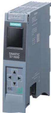
SIMATIC S7-1500R, CPU 1513R-1PN, unità centrale con memoria di lavoro 600 KB per il programma e 2,5 MB per i dati, 1ª interfaccia: PROFINET RT con switch a 2 porte, necessaria SIMATIC Memory Card
