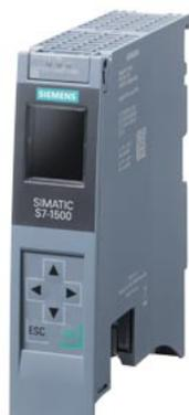
SIMATIC S7-1500, CPU 1513-1 PN, unità centrale con memoria di lavoro 600 KB per il programma e 2,5 MB per i dati, 1ª interfaccia: PROFINET IRT con switch a 2 porte, performance a bit di 25 ns, necessaria SIMATIC Memory Card \*\*\*\* osservare omologazioni e certificato secondo articolo 109815653 su [support.industry.siemens.com](http://support.industry.siemens.com) ! \*\*\*\*
