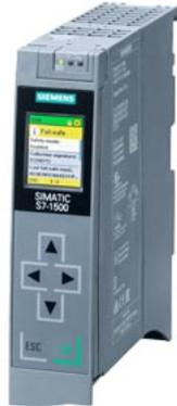
SIMATIC S7-1500T, CPU 1511TF-1 PN, unità centrale con memoria di lavoro 225 KB per il programma e 1 MB per i dati, 1ª interfaccia: PROFINET IRT con 2 Port Switch, performance a bit di 60 ns, SIMATIC Memory Card necessaria
