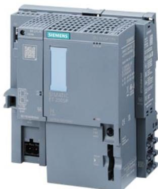
SIMATIC DP, CPU 1510SP-1 PN per ET 200SP, unità centrale con memoria di lavoro 200 KB per il programma e 1 MB per i dati, 1ª interfaccia: PROFINET IRT con switch a 3 porte, performance a bit di 25 ns, necessaria SIMATIC Memory Card, BusAdapter necessario per porta 1 e 2 \* \*\*\* osservare omologazioni e certificati secondo articolo 109817615 su support.industry.siemens.com ! \*\*\*\*
