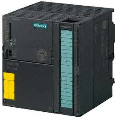
SIMATIC S7-300, CPU 317TF-3 PN/DP, unità centrale per PLC, compiti tecnologici e compiti SAFETY, memoria di lavoro 1,5MB, 1a interf. MPI/DP 12Mbit/s, 2a interf. DP (drive), 3a interf. Ethernet PROFINET con 2 Port Switch, I/O integr. per la tecnologia, connettore frontale (1 x 40 poli) e Micro Memory Card min. 8 MB necessari
