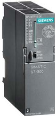
SIMATIC S7-300, CPU 317F-2DP, unità centrale con memoria di lavoro 1,5MB, 1a interf. MPI/DP 12Mbit/s, 2a interf. master/slave DP, Micro Memory Card necessaria impiegabile con il pacchetto software S7 Distributed Safety da V5.2 SP1
