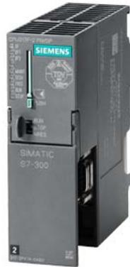
CPU SIMATIC S7-300 317F-2 PN/DP, unità centrale con memoria di lavoro 1,5MB, 1a interf. MPI/DP 12Mbit/s, 2a interf. Ethernet PROFINET, con 2 Port Switch, Micro Memory Card necessaria
