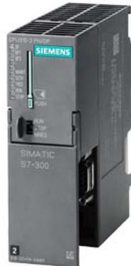
CPU SIMATIC S7-300 315-2 PN/DP, unità centrale con memoria di lavoro 384 kbyte, 1a interf. MPI/DP 12Mbit/s, 2a interf. Ethernet PROFINET, con 2 Port Switch, Micro Memory Card necessaria
