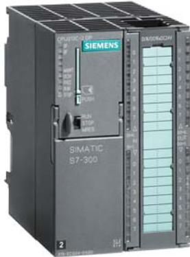
SIMATIC S7-300, CPU 313C-2 DP CPU compatta con MPI, 16 DI/16 DO, 3 contatori veloci (30 kHz), interfaccia DP integrata, alimentazione di corrente DC 24 V integr., memoria di lavoro 128 kbyte, connettore frontale (1 x 40 poli) e Micro Memory Card necessaria
