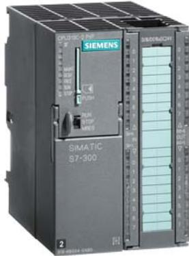
SIMATIC S7-300, CPU 313C-2 PTP CPU compatta con MPI, 16 DI/16 DO, 3 contatori veloci (30 kHz), interfaccia RS485 integrata, alimentazione di corrente DC 24 V integr., memoria di lavoro 128 kbyte, connettore frontale (1 x 40 poli) e Micro Memory Card necessaria
