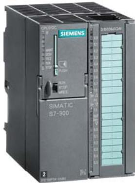
SIMATIC S7-300, CPU 312C CPU compatta con MPI, 10 DI/6 DO, 2 contatori veloci (10 kHz) alimentatore DC 24 V integr., Memoria di lavoro da 64 kbyte, connettore frontale (1 x 40 poli) e Micro Memory Card necessaria
