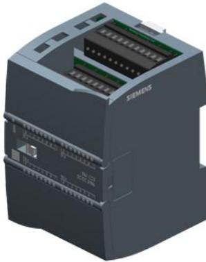
SIMATIC S7-1200, I/O digitali SM 1223, 16 DI/16 DO, 16 DI DC 24V, lettura su M/P, 16 DO, commutazione su M (sinking output), transistor NPN 0,5A
