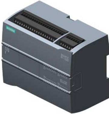
SIMATIC S7-1200, CPU 1215C, CPU compatta, DC/DC/relè, 2 porte PROFINET, I/O onboard: 14 DI DC 24 V; 10 DO relè 2A, 2 AI 0...10V DC, 2 AO DC 0...20mA, alimentazione: DC DC 20,4...28,8V, memoria di programma / memoria dati 200 KB
