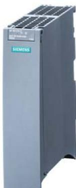
SIMATIC ET 200MP. PROFINET IO Device modulo d'interfaccia IM 155-5 PN HF, per moduli di elettronica ET 200MP; fino a 12 moduli IO senza PS; fino a 30 moduli IO con PS aggiuntivo; switch a 2 porte integrato; RJ45 Shared Device; MRP; IRT  $\geq 0,25\text{ms}$ ; sincronismo di clock update FW; I&M0...3; avviamento prioritizzato, ridondanza S2; Shared Device con 4 Controller adatto per il funzionamento con il bus backplane attivo (da FW V4.4)
