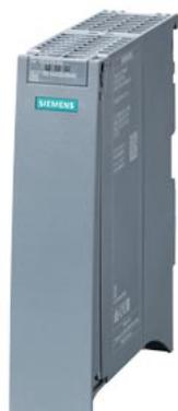
SIMATIC ET 200MP PROFINET IO Device modulo d'interfaccia IM 155-5 PN BA per moduli di elettronica ET 200MP; fino a 12 moduli IO, switch a 2 porte integrato; RJ45 Shared Device con 2 IO Controller; MRP; update FW; I&M0...3;
