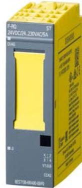
SIMATIC DP, modulo di elettronica per ET200SP, F-RQ 1x 24VDC/24..230VAC/5A ST, Largh. costr. 20 mm, 1 uscita a relè (2S) corrente di uscita totale 5A, tensione di carico DC 24V e AC 24.. 230V, impiegabile fino a PL E (ISO 13849-1: 2008)/ SIL 3 (IEC 61508: 2010) se comandato tramite F-DQ (ad es. 6ES7136-6DB00-0CA0).
