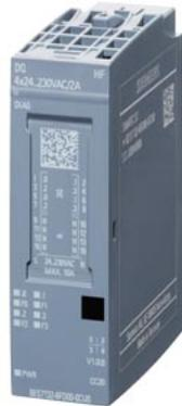
SIMATIC ET 200SP, Modulo di uscite digitali, DQ 4x 24..230V AC/2A HF, Unità di confezionamento: 1 pezzo due modi di funzionamento alternativi: DQ e controllo della potenza, adatto per BU tipo U0, codice colore CC20, diagnostica di canale
