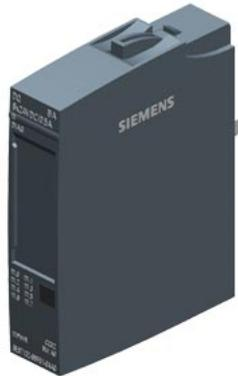
SIMATIC ET 200SP, modulo di uscite digitali, DQ 8x 24V DC/0,5A Basic, Source Output (PNP,Commutazione su P) Unità di confezionamento: 1 pezzo adatto per BU tipo A0. Codice colore CC02, emissione del valore sostitutivo, Modulo diagnostica per: tensione di alimentazione
