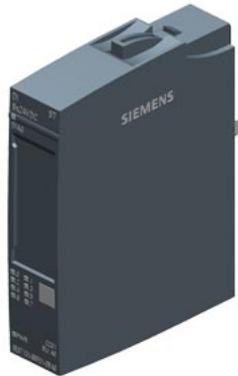
SIMATIC ET 200SP, Modulo di ingressi digitali, DI 8x 24V DC Basic, tipo di ingresso 2 (IEC 61131), Sink Input, (PNP, lettura su P), Unità di confezionamento: 10 pezzi, adatto per BU tipo A0, Codice colore CC01, Ritardo di ingresso 0,05..20ms; Modulo diagnostica per: tensione di alimentazione
