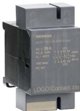
LOGO! Contact 230 Modulo di comando per il comando diretto di carichi ohmici fino a 20A e motori fino a 4kW, AC 230V, 3 contatti NO+1 NC EAN: 4025515050759
