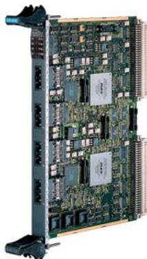
SIMATIC TDC unità di comunicazione CP52IO unità d'interfaccia per global Data Memory (GDM) con 4 interfacce
