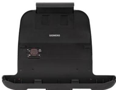
SIMATIC IPC MD-34A Vehicle Dock accessori; MD-34A tutte le configurazioni; 1x LAN 10/100 Mbps/s, 2x USB 2.0; 1x RS-232; 1x VGA, ingresso DC 9...36 V laterale; 2x USB 2.0; è necessario selezionare il cavo di collegamento alla rete; nota: a causa del design meccanico del modulo RFID, la versione High End e Automation non possono essere adattati alla Vehicle Docking Station
