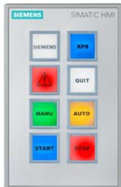
SIMATIC HMI KP8 PN Key Panel, 8 tasti a corsa corta con LED multicolore, Interfacce PROFINET 8 pin DI/DO configurabili, DC 24V collegabile in cascata parametrizzabile da STEP 7 V5.5
