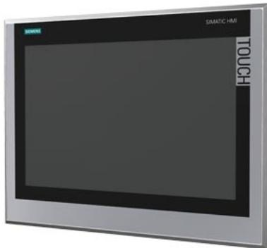
SIMATIC HMI TP1500 Comfort INOX frontale in acciaio inox, pellicola decorativa ininterrotta, grado di protezione del frontale IP66K, display TFT 15" widescreen, interfaccia PROFINET, interfaccia MPI/PROFIBUS DP, memoria di progettazione da 24 MB, Windows CE 2013, progettabile da WinCC Comfort V14 SP1 con HSP
