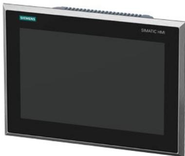
SIMATIC HMI TP1200 Comfort INOX frontale in acciaio inox, lastra di vetro, Touch capacitivo, grado di protezione parte frontale IP69K, display TFT widescreen da 12", interfaccia PROFINET, interfaccia MPI/PROFIBUS DP, memoria di progettazione 12 Mbyte, Windows CE 6.0, (supporto Microsoft, inclusi gli aggiornamenti di sicurezza, terminato) progettabile da WinCC Comfort V15
