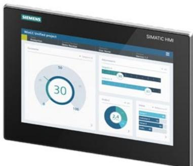
SIMATIC HMI MTP1200, Unified Comfort Panel, comando touch, display TFT widescreen da 12,1", 16 milioni di colori, interfaccia PROFINET, progettabile da WinCC Unified Comfort V16, comprende il software Open Source che viene concesso gratuitamente, vedere il DVD allegato
