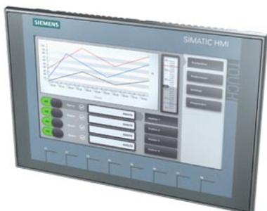
SIMATIC HMI, KTP900 Basic, Basic Panel, Comando a tasti/touch, display TFT da 9", 65536 colori, interfaccia PROFINET, progettabile da WinCC Basic V13/ STEP 7 Basic V13, comprende il software Open Source, Il fornito a titolo gratuito vedere il CD allegato
