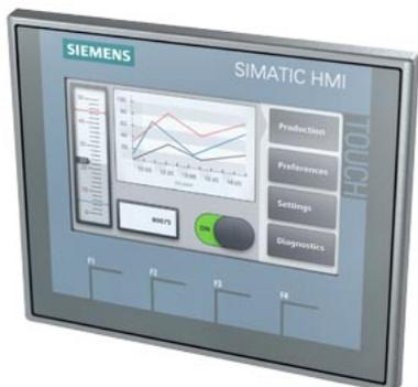
SIMATIC HMI, KTP400 Basic, Basic Panel, comando a tasti/touch, display TFT da 4", 65536 colori, interfaccia PROFINET, progettabile da WinCC Basic V13/ STEP 7 Basic V13, comprende il software Open Source, Il fornito a titolo gratuito vedere il CD allegato
