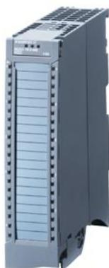
SIPLUS S7-1500 AI 8xU/I HS TX RAIL basato su 6ES7531-7NF10-0AB0 con Conformal Coating, -40 ... +70 °C, OT4 con ST1/2 (+85°C per 10min), modulo di ingressi analogici risoluzione 16 bit, precisione 0,3%, 8 canali in gruppi di 8, tensione di modo comune 10V; diagnostica; interrupt di processo 8 canali in 0,0625 ms incl. elemento di alimentazione, clip e morsetto per schermo
