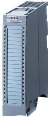
SIPLUS S7-1500 AI 8xU/I/RTD/TC TX RAIL basato su 6ES7531-7KF00-0AB0 con Conformal Coating, -40 ... +70 °C, OT4 con ST1/2 (+85°C per 10min), modulo di ingressi analogici risoluzione 16 bit, precisione 0,3%, 8 canali in gruppi di 8, 4 canali per misura RTD, tensione di modo comune 10V; diagnostica; interrupt di processo incl. elemento di alimentazione, clip e morsetto per schermo
