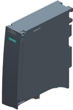
SIPLUS ET 200MP IM155-5 PN ST TX RAIL basato su 6ES7155-5AA01-0AB0 con Conformal Coating, -40 ... +70 °C, OT4 con ST1/2 (+85°C per 10min), PROFINET IO Device modulo d'interfaccia per moduli di elettronica ET 200MP; fino a 12 moduli IO senza PS; fino a 30 moduli IO con PS aggiuntivo; integrato switch a 2 porte; RJ45 Shared Device; MRP; IRT >=0,25ms; sincronismo di clock aggiornamento FW; I&M0...3; con 500 ms
