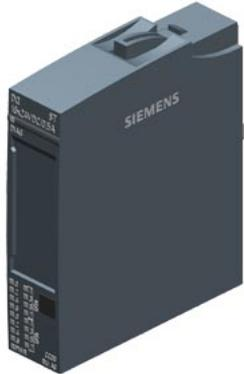
SIPLUS ET 200SP DQ 16x DC 24V/ 0,5A TX RAIL basato su 6ES7132-6BH01-0BA0 con Conformal Coating, -40 ... +70 °C, OT4 con ST1/2 (+85°C per 10min), modulo di uscite digitali, adatto per BU tipo A0, codice colore CC00, Source Output (PNP, commutazione su P) emissione del valore sostitutivo, modulo diagnostica per: cortocircuito verso L+ e M, rottura conduttore, tensione di alimentazione
