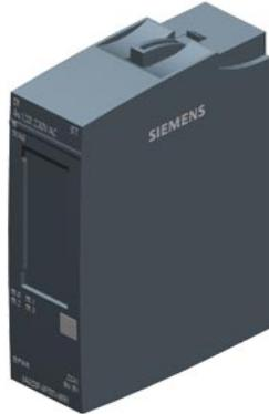
SIPLUS ET 200SP DI 4x120/ AC 230V TX RAIL basato su 6ES7131-6FD01-0BB1 con Conformal Coating, -40 ... +70 °C, OT4 con ST1/2 (+85°C per 10min), modulo di ingressi digitali, adatto per BU tipo B1, codice colore CC41, diagnostica di modulo tipo di ingresso 3 (IEC 61131),
