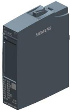
SIPLUS ET 200SP DI 16x DC 24V ST TX RAIL basato su 6ES7131-6BH01-0BA0 con Conformal Coating, -40 ... +70 °C, OT4 con ST1/2 (+85°C per 10min), modulo di ingressi digitali, adatto per BU tipo A0, codice colore CC00, tipo di ingresso 3 (IEC 61131), ingresso sink, (PNP, lettura su P), ritardo in ingresso 0,05..20ms modulo diagnostica per: rottura conduttore, tensione di alimentazione
