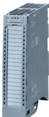
SIPLUS S7-1500 AI 8xU/I HF basato su 6ES7531-7NF00-0AB0 con Conformal Coating, -40 ... +70 °C, avvio a -25 °C, modulo di ingressi analogici risoluzione 16 bit, precisione 0,1%, 8 canali in gruppi di 1; tensione di modo comune: AC 30V/DC 60V, diagnostica; interrupt di processo; incl. elemento di alimentazione, clip e morsetto per schermo
