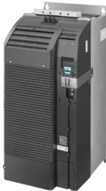
SIPLUS G120 PM240-2 IP20-FSF-A-400V 132kW basato su 6SL3210-1PE32-5AL0 con Conformal Coating, -20...+50°C, con filtro integrato classe A con chopper di frenatura integrato 3AC 380 ... 480V +10/-20% 47 ... 63 Hz potenza sovraccarico elevato: 110 kW al 200% 3s, 150% 57s, 100% 240s potenza sovraccarico ridotto: 132kW al 150% 3s, 110% 57s, 100% 240s 708x 305x 357 (AxLaxP), forma costruttiva FSF, grado di protezione IP20 senza CU e pannello di comando omologato dalla versione FW CU V4.7 HF8
