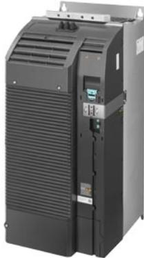
SIPLUS G120 PM240-2 IP20-FSF-U-400V 75kW basato su 6SL3210-1PE31-5UL0 con Conformal Coating, -20...+50°C, non filtrato con chopper di frenatura integrato 3AC 380 ... 480V +10/-20% 47 ... 63 Hz potenza sovraccarico elevato: 55 kW al 200% 3s, 150% 57s, 100% 240s potenza sovraccarico ridotto: 75 kW al 150% 3s, 110% 57s, 100% 240s 708x 305x 357 (AxLaxP), forma costruttiva FSF, grado di protezione IP20 senza CU e pannello di comando omologato dalla versione FW CU V4.7 HF8
