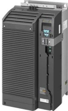
SIPLUS G120 PM240-2 IP20-FSE-A-400V 45kW basato su 6SL3210-1PE28-8AL0 con Conformal Coating, -20...+50°C, con filtro integrato classe A con chopper di frenatura integrato 3AC 380 ... 480V +10/-20% 47 ... 63 Hz potenza sovraccarico elevato: 37 kW al 200% 3s, 150% 57s, 100% 240s potenza sovraccarico ridotto: 45 kW al 150% 3s, 110% 57s, 100% 240s 551x 275x 237 (AxLxP), forma costruttiva FSE, grado di protezione IP20 senza CU e pannello di comando omologato dalla versione FW CU V4.7 HF8
