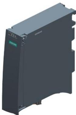
SIPLUS ET 200MP IM155-5 PN ST basato su 6ES7155-5AA01-0AB0 con Conformal Coating, -40 ... +70 °C, PROFINET IO Device modulo d'interfaccia per moduli di elettronica ET 200MP; fino a 12 moduli IO senza PS; fino a 30 moduli IO con PS aggiuntivo; integrato switch a 2 porte; RJ45 Shared Device; MRP; IRT >=0,25ms; sincronismo di clock aggiornamento FW; I&M0...3; con 500 ms
