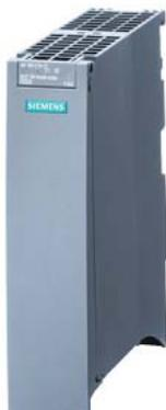
SIPLUS ET 200MP IM155-5 PN HF basato su 6ES7155-5AA00-0AC0 con Conformal Coating, -40 ... +60 °C, PROFINET IO Device modulo d'interfaccia per moduli di elettronica ET 200MP; fino a 12 moduli IO senza PS; fino a 30 moduli IO con PS aggiuntivo; integrato switch a 2 porte; RJ45 Shared Device; MRP; IRT >=0,25ms; sincronismo di clock aggiornamento FW; IM0...3; avviamento prioritizzato ridondanza S2; Shared Device
