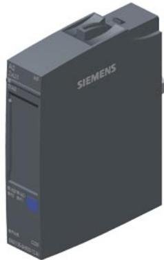
SIPLUS ET 200SP AQ 2xU/I HF basato su 6ES7135-6HB00-0CA1 con Conformal Coating, -40 ... +70 °C, modulo di uscite analogiche, adatto per BU tipo A0, A1, codice colore CC00, diagnostica di canale, 16 bit, +/-0,1%
