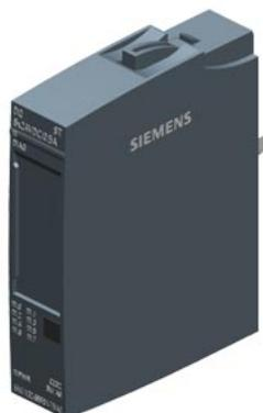
SIPLUS ET 200SP DQ 8x DC 24V/0,5A Standard basato su 6ES7132-6BF01-0BA0 con Conformal Coating, -40 ... +70 °C, modulo di uscite digitali, adatto per BU tipo A0, codice colore CC02, diagnostica di canale,
