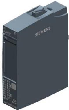
SIPLUS ET 200SP DI 8x DC 24V SRC BA basato su 6ES7131-6BF61-0AA0 con Conformal Coating, -40 ... +70 °C, modulo di ingressi digitali, adatto per BU tipo A0, codice colore CC02, Source Input, (NPN, con lettura su M) tipo di ingresso 1 (IEC 61131), ritardo in ingresso 0,05..20ms modulo diagnostica per: tensione di alimentazione
