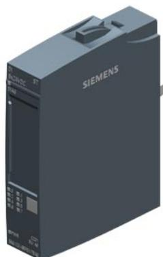
SIPLUS ET 200SP DI 8x DC 24V standard basato su 6ES7131-6BF01-0BA0 con Conformal Coating, -40 ... +70 °C, modulo di ingressi digitali, adatto per BU tipo A0, codice colore CC01, ingresso sink, (PNP, lettura su P), tipo di ingresso 3 (IEC 61131), ritardo in ingresso 0,05..20ms modulo diagnostica per: cortocircuito alimentazione trasduttore, rottura conduttore, tensione di alimentazione
