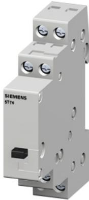
Interruttore con comando a distanza con 1 contatto NO, con funzione on-off centralizzato contatto per AC 230V, 400V 16A comando in AC 24V
