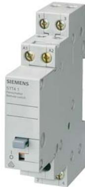
interruttore con comando a distanza con 2 contatti NO, contatto per AC 230V, 400V 16A comando in AC 230V
