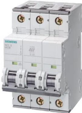
Interruttore magnetotermico 400V 10 kA, a 3 poli, C, 5A, P=70mm
