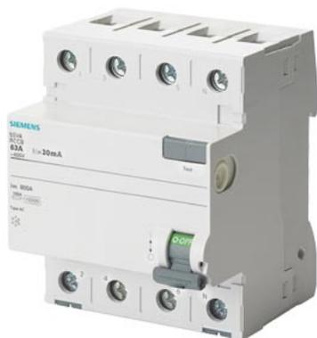
interruttore automatico differenziale, a 4 poli, Tipo AC, In: 40 A, 30 mA, Un AC: 400 V
