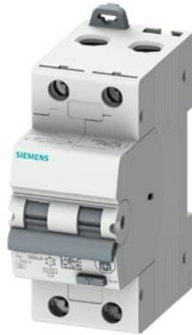
interruttore magnetotermico differenziale, 6 kA, 2P tipo A, 30 mA, car. B, In: 06 A
