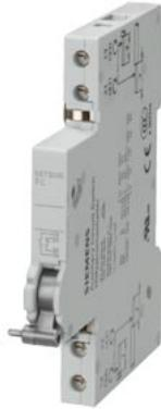
blocchetto di contatti di segnalazione errore 1 NO + 1 NC per interruttori magnetotermici 5SL, 5SY, 5SP interruttore magnetotermico/differenziale 5SU1, interruttore differenziale 5SV (per 5SU1 l'elemento di connessione per leva di comando 5ST3805-1 è necessario)
